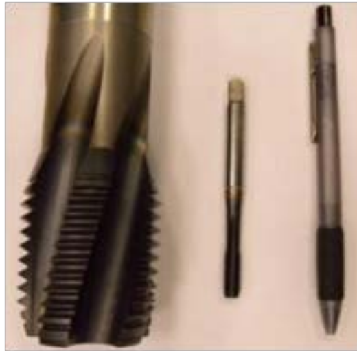
Figura 4.65: Muestra de los machos de roscar ensayados, de M52 y M8
