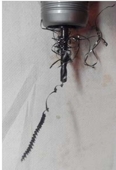
Figura 4.48 Ejemplo de viruta embotada en el macho, al roscar acero dúctil F-1252
