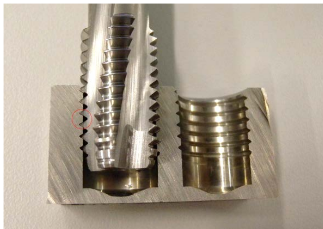
Figura 1.7: Sección roscada con macho de roscar con ángulo de hélice
