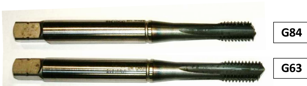
Figura 4.46: Rotura de dos machos al roscar en rígido con las instrucciones G84 y G63 a V_c=10 m/min
