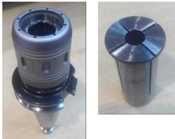
Figura 4.33: Portaherramientas y boquilla hidráulica calibrada
