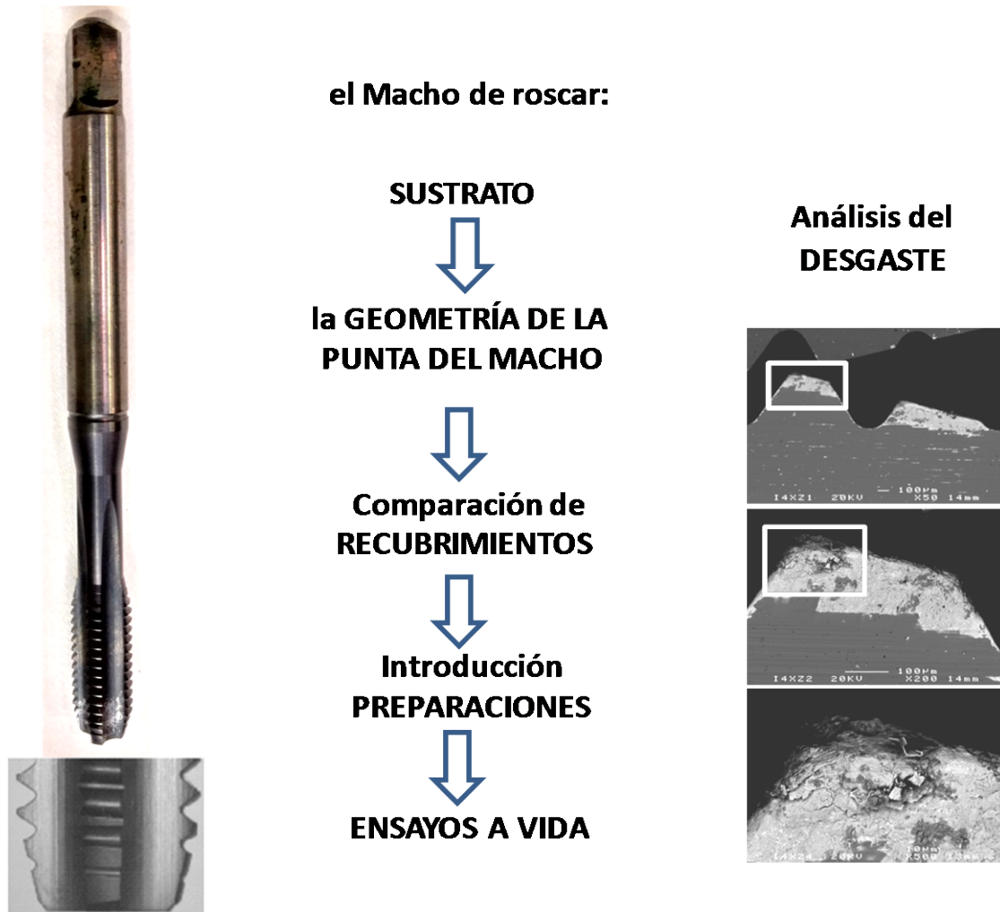
Figura 3.2: Esquema de las características del macho de roscar
