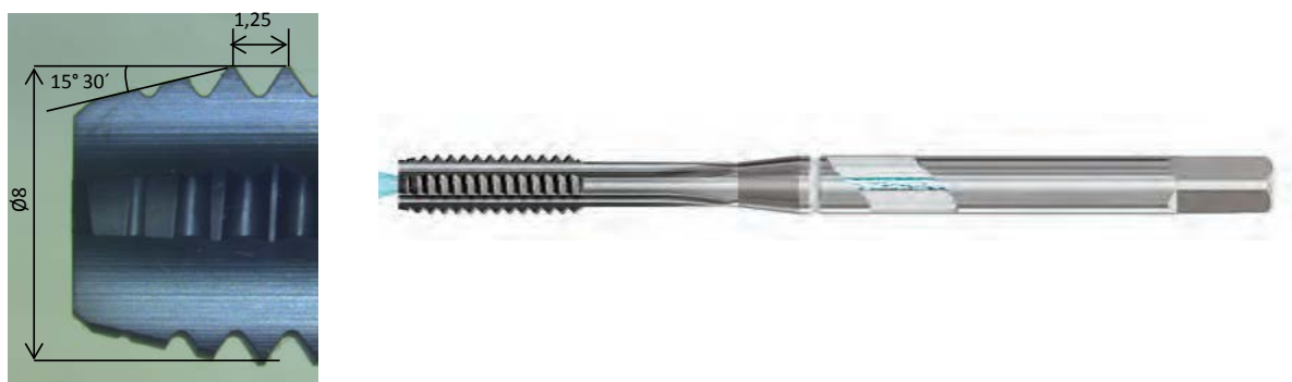
Figura 4.2: Macho de M8 empleado. Detalle de la punta: dientes y ángulo de chaflán y paso de la rosca
