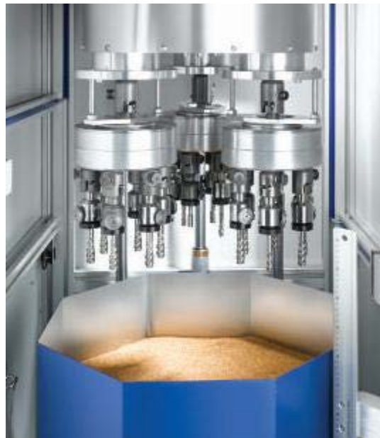
Figura 3.14: Equipos de pretratamiento superficial de herramientas de pulido orbital (drag grinding) (Fuente: OTEC®)
