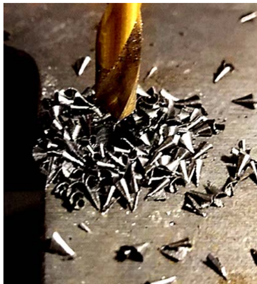
Figura 4.5: Viruta de ADI, muy corta y fragmentada
