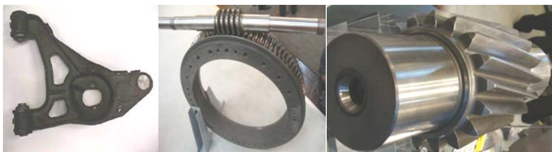
Figura 1.12: Soporte de suspensión, coronas y piñones industriales
