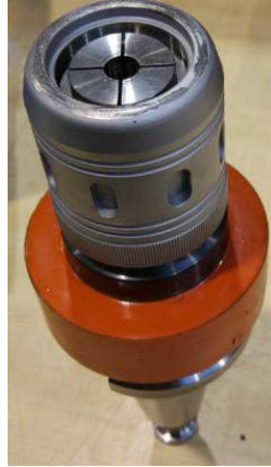
Figura 4.31: Montaje para roscado rígido con el adaptador HSK y con la anilla del Artis DDU®
