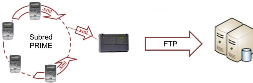
Figura 33. Esquema de una tarea programada para petición de datos de medida a los SMS.
