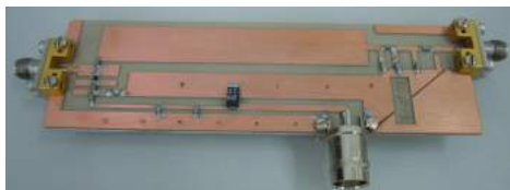
Figure 3.25: Fotografía del divisor de frecuencia.
