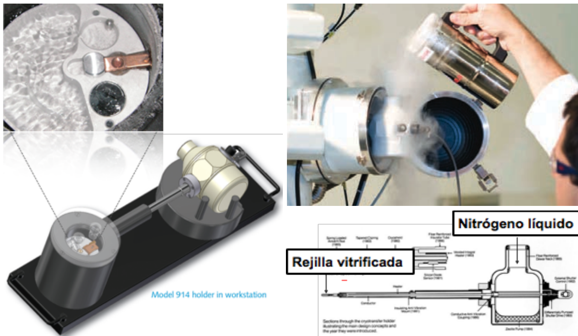
Figura 2.3: Imágenes del proceso de transferencia de una rejilla vitrificada dentro del vacío del TEM utilizando un porta-muestras Gatan con el dewar lleno de nitrógeno líquido
