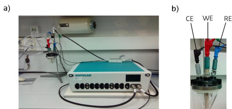
Figura 13. a) Voltámetro Metrohm Autolab. b) Celda electroquímica; WE: electrodo de trabajo, RE: electrodo de referencia, CE: contra-electrodo.
