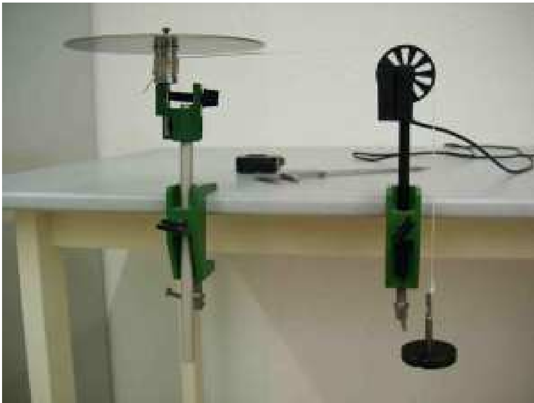
Diskoaren inertzia-momentua neurtzeko tresna
