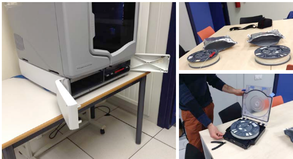
Fig. 40.- Bobinas de material de soporte y constructivo y su disposición en la impresora.
