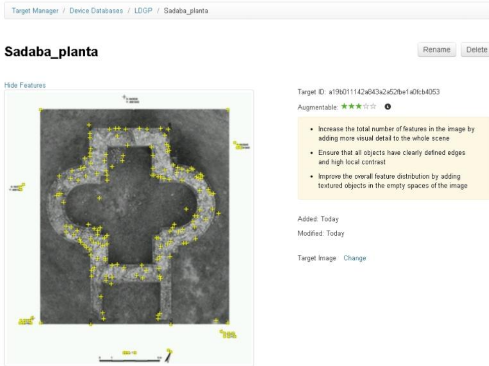
Fig. 47.- Características identificables sobre el marcador (a mayor número de puntos, mayores posibilidades de enlazar el modelo 3D)
