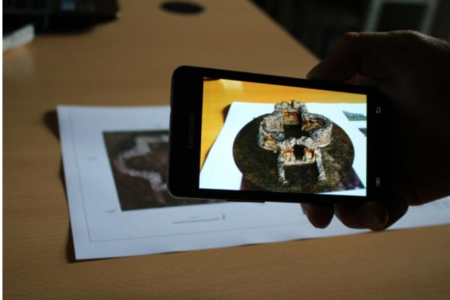
Fig. 49.- Modelo 3D sobreimpuesto sobre la imagen utilizada como marcador (plano en papel).
