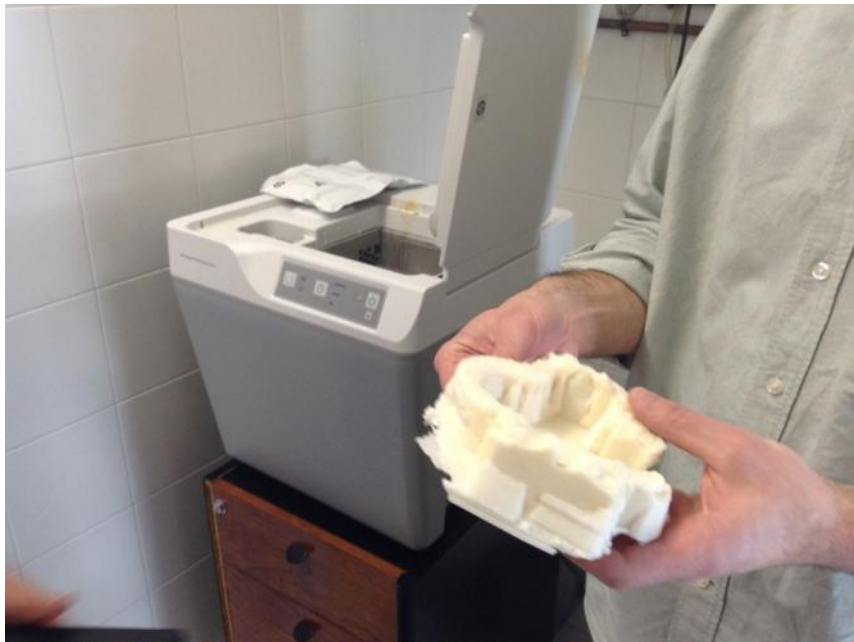
Fig. 42.- Dispositivo HP Designjet 3D Removal System y modelo del Mausoleo previo a su proceso de lavado.
