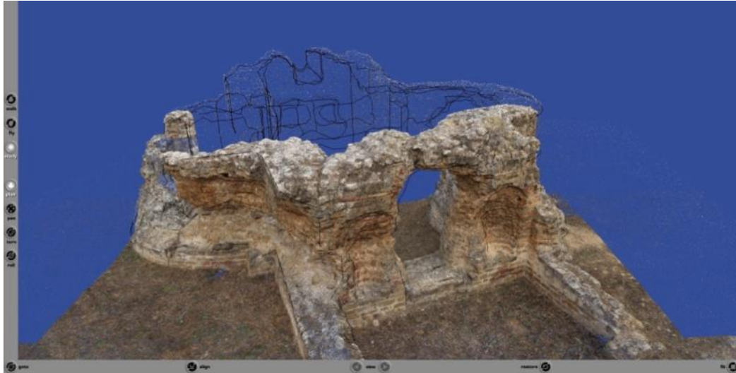
Fig. 36.- Modelo virtual de puntos preparado con niveles de detalle para su visualizador en un navegador web convencional.
