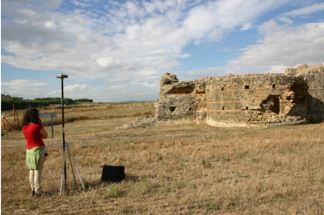
Fig. 4.- Observación GNSS en una de las estaciones de la red.
