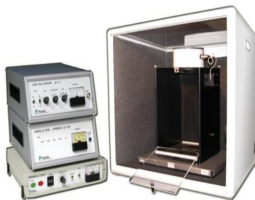
Imagen 2. Caja de atenuación e interfaces del sistema combinado StarFear . PanLab S.L.U.
