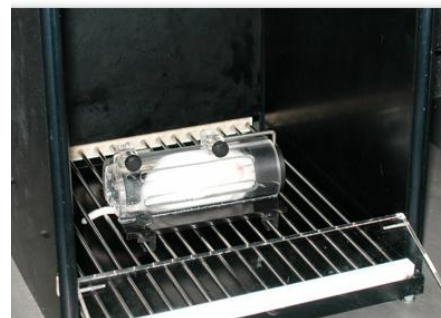
Imagen 1. Cilindro de restricción del sistema combinado StarFear . PanLab S.L.U.
