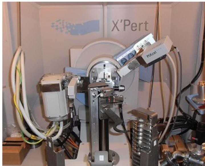
**Figura 2.2.2:** Difractor de Rayos-X de la UPV-EHU.
