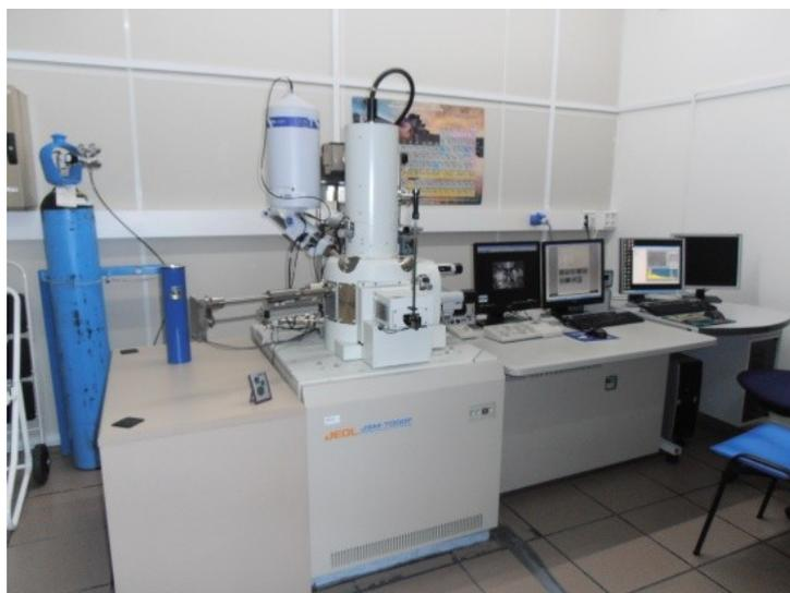
**Figura 2.2.4: Fotografía del microscopio electrónico de barrido de la UPV-EHU.**
