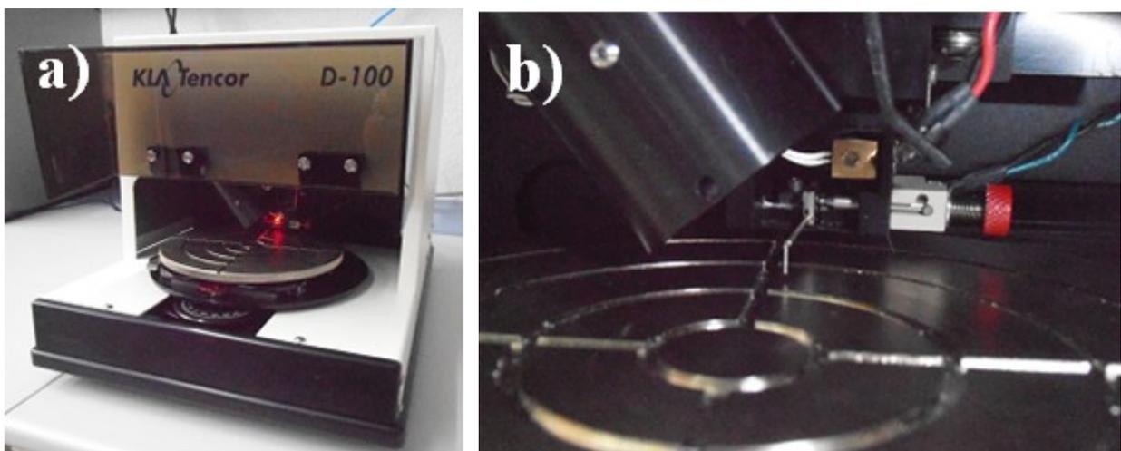
Figura 2.2.5: a) Perfilómetro de la UPV-EHU. b) El interior del perfilómetro, donde se realizan las medidas.
