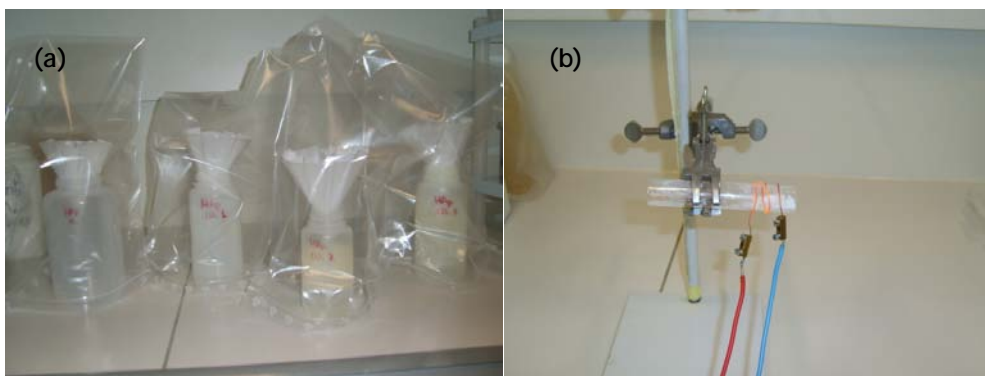
Figura 4.20. Procedimiento de síntesis de HAp: (a) Filtración del precipitado; (b) Tratamiento térmico.
