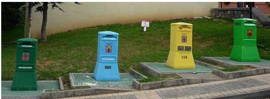
Foto 52: Contenedores selectivos de recogida de basura, en Aduna. El depósito está enterrado y la extracción se hace mediante un sistema hidráulico. (Autoría: Miren Urquijo, © CC BY-SA.)
