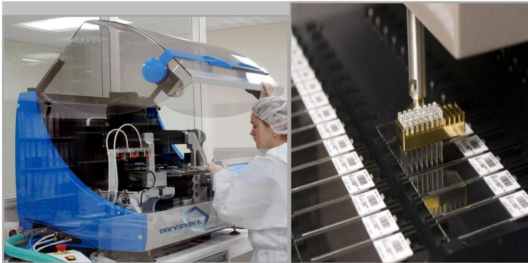
**Figura 20.-** Fotografías de un robot Modelo MicroGrid 610 con el que se ha producido el chip de genotipado. En la fotografía de la izquierda se muestra el robot completo mientras que en la fotografía de la derecha se muestran los portaobjetos ordenados en una de las bandejas del robot y el brazo con las puntas (pinholes) que depositan los oligonucleótidos sobre su superficie.
