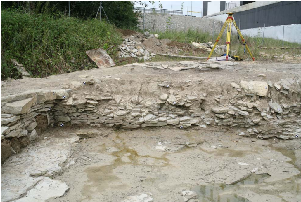
Fig. 5.- Observación GPS estática en una de las estaciones.
