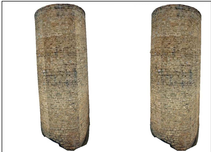
Figura 8: Modelo parcial de una torre cilíndrica con ajuste de medias y desviaciones (a la izquierda) y con el mismo ajuste pero además incluyendo el cálculo del gradiente (a la derecha), se puede apreciar una reducción del efecto de bandeo y, por lo tanto, una mayor continuidad en la textura.
