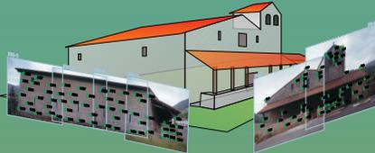
La documentación fotogramétrica consiste en una colección de pares convenientemente apoyados topográficamente y clasificados. Si es posible, se preseñaliza el apoyo mediante señales de puntería ya que estas señales agilizan en gran medida los procesos posteriores y mejoran la precisión final.
