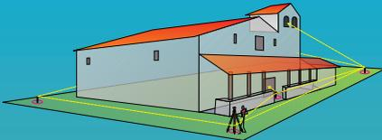
La red de estaciones debe abarcar todas las zonas del edificio que se quieran documentar. Esto supone, generalmente, desarrollar varios itinerarios a diferentes niveles (exterior, planta baja, sótano, . . .). La precisión de las coordenadas depende del instrumental utilizado, el método de trabajo y el diseño de la red.
