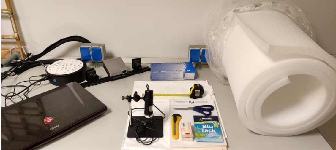
Fig. 4.- Equipo utilizado en las pruebas iniciales. Por un lado, se muestra el proyector y cámaras del escáner de luz estructurada y, por otro lado, una cámara macro. Asimismo, el material auxiliar para el manejo y sujeción de las muestras durante las medidas.
