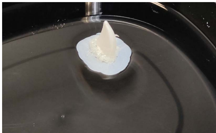
Fig. 36.- La pieza con el material de soporte se introduce en un recipiente con agua que procederá a disolver dicho material dejando sólo la parte correspondiente al modelo 3D.
