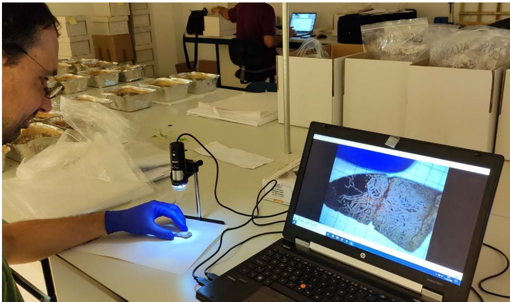
Fig. 14.- Fotografía macro portátil. La cámara se conecta al equipo portátil desde donde se realiza la captura de las imágenes.
