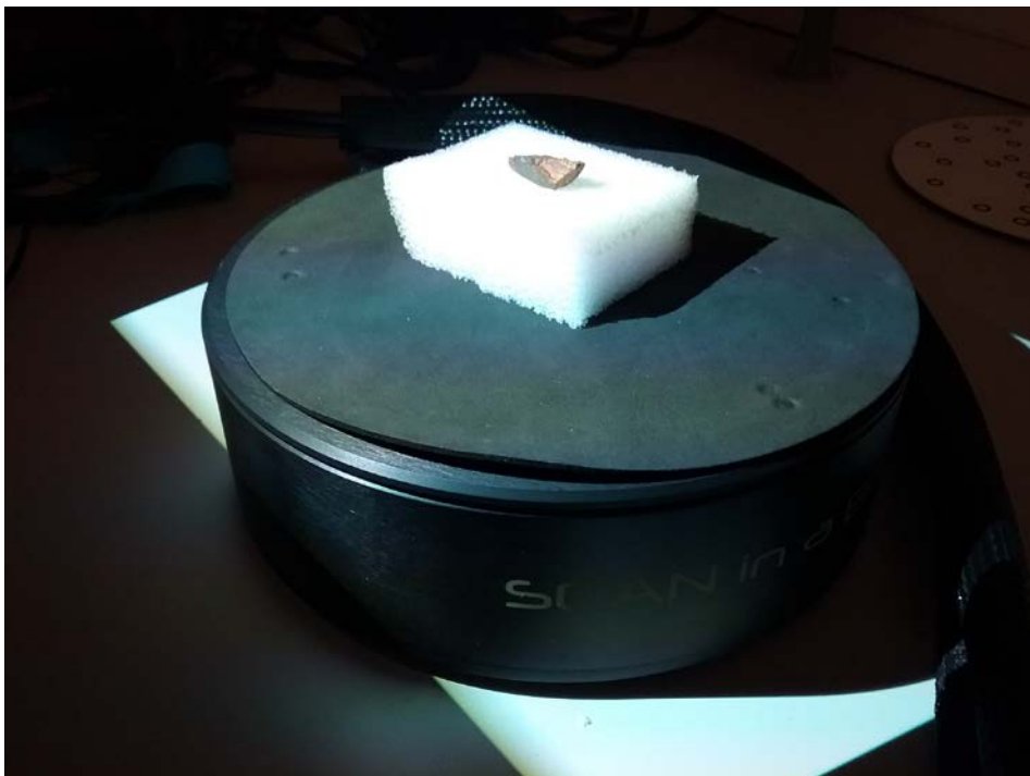
Fig. 6.- Mesa rotatoria del sistema de luz estructurada sobre el que se sitúa la pieza a escanear sobre la base de espuma.
