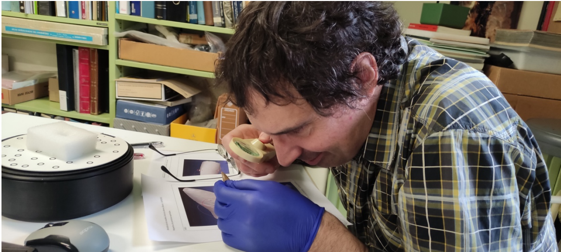
Fig. 30.- Comprobación visual de los efectos extraños y dudas sobre los modelos 3D para comprobar si, efectivamente, se trata de irregularidades existentes en las piezas escaneadas.
