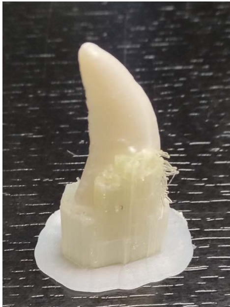
Fig. 35.- Pieza obtenida de la impresora que aún tiene el material de soporte.
