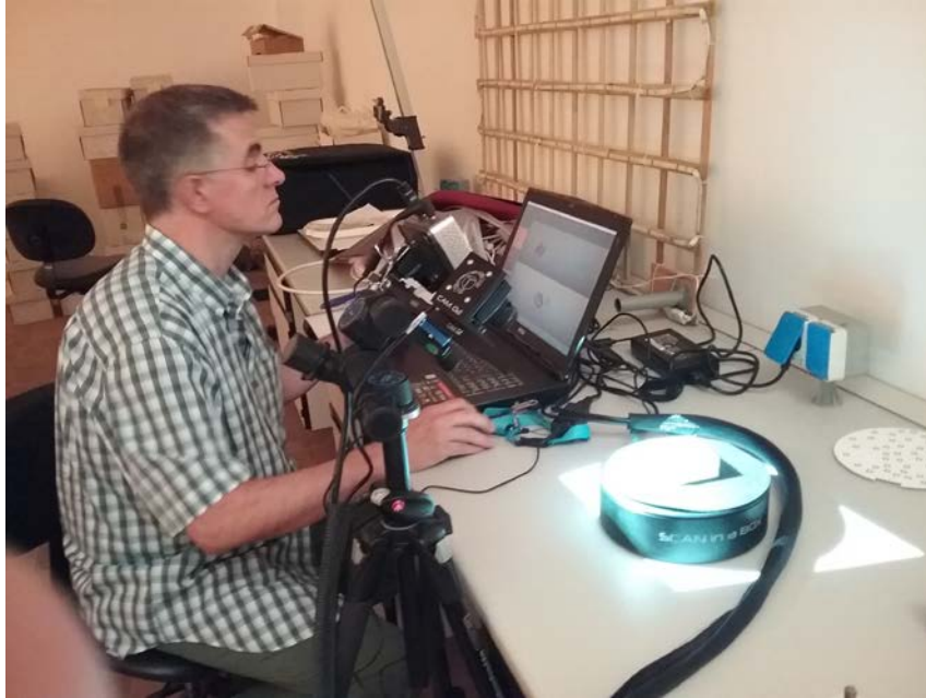
Fig. 5.- Escaneado de luz estructurada. En primer plano se aprecia el conjunto de proyector y dos cámaras sobre trípode que está recogiendo información de la pieza situada en la mesa giratoria. Detrás el usuario que maneja el ordenador portátil que controla las tomas y muestra los escaneados.
