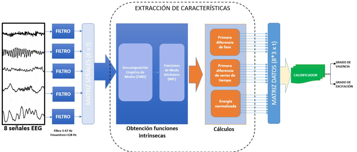
Figura 21. Diseño final del sistema
