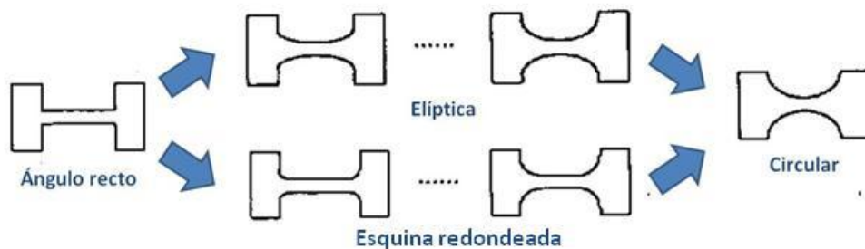
Figura 16. Variaciones en la transición de las juntas en voladizo a las juntas tipo muesca circular
