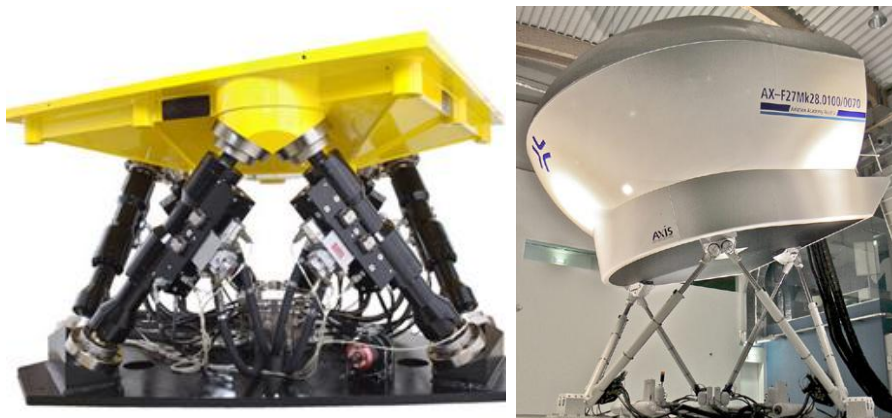
Figura 37. a) (Ejemplo de manipulador MAST [43]. b) Plataforma paralela empleada como simulador de vuelo [44]
