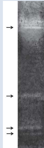
FIG 1 - Zimogramma con carbossimetil-chitina (CM-chitin-RBV) come substrato. L'analisi rivela che la miscela di chitinasi da T. viride è composta da quattro diversi enzimi con attività chitinolitica (→).
