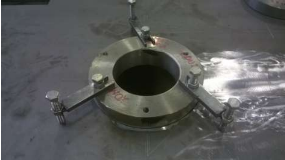
Slika 4.67: Način postavljanja prirubnice nisko naponske strane
