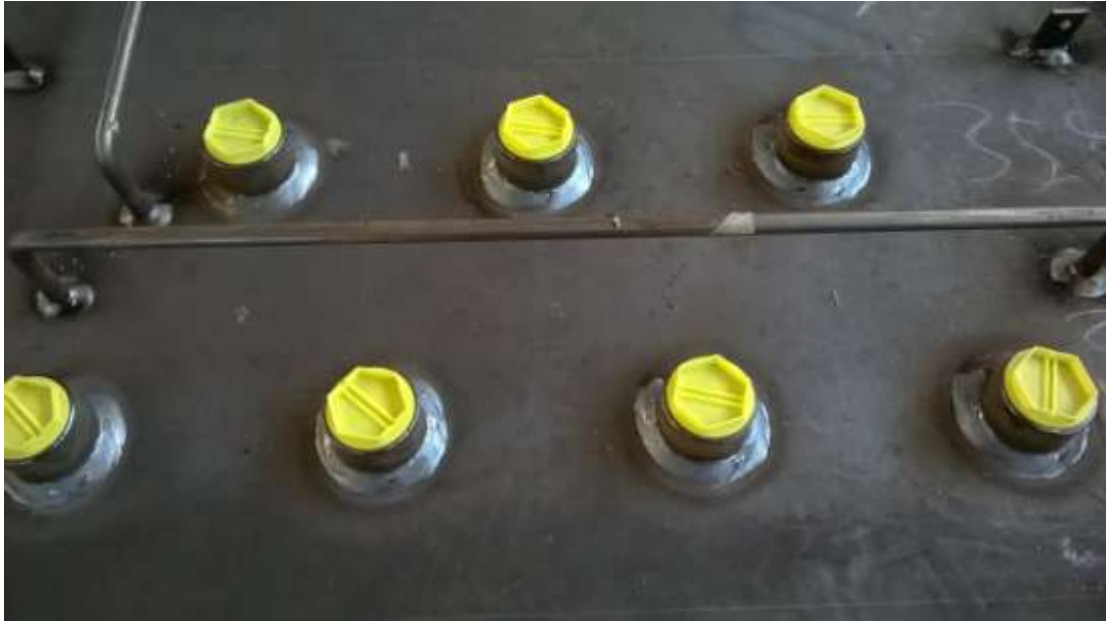
Slika 6.2: Zaštita čahura za termometar prije sačmarenja
