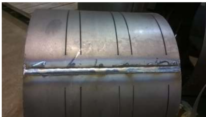
Slika 4.30: Savinuti i zavareni plaševi triju kupola 1U, 1V, 1W
