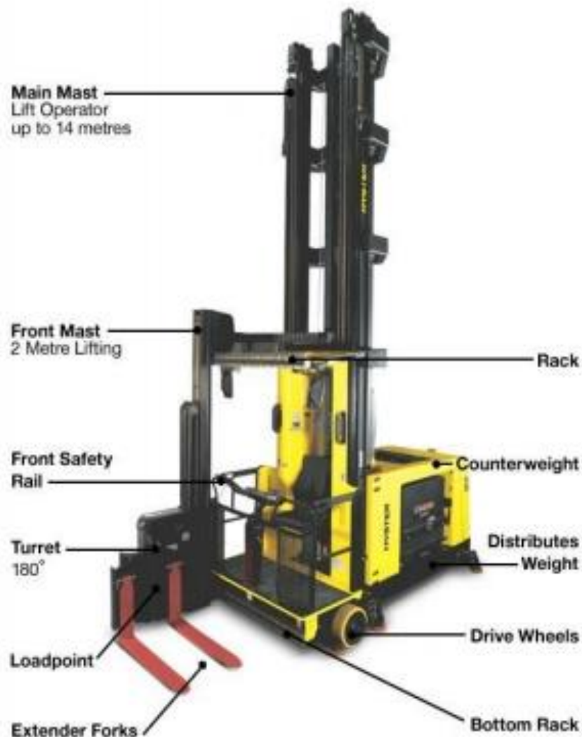
Slika 3.1.: Viličar sa zakretnim vilicama i njegovi dijelovi [24]
