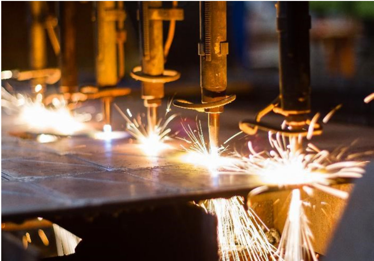
Fig. 2: Taglio di materiale metallico con appositi macchinari. Foto di Shutterstock.com.
