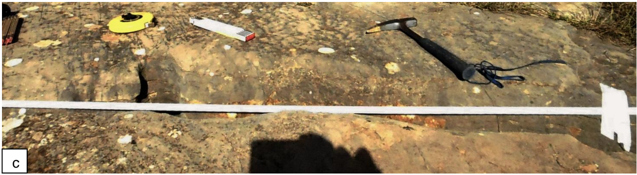
Figura 42 – a) Proiezione dei piani delle fratture e b) divisione in cluster; c) posizione della scan line n° 8.
