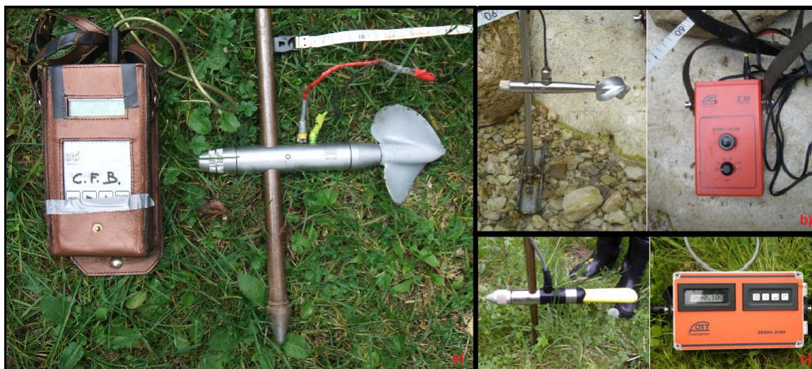
Figura 3.1 – Strumenti utilizzati per la realizzazione delle misure di portata: a) mulinello idrometrico e contatore elettronico; b) micro mulinello idrometrico e contagiri; c) correntometro ad induzione magnetica e misuratore della velocità.
