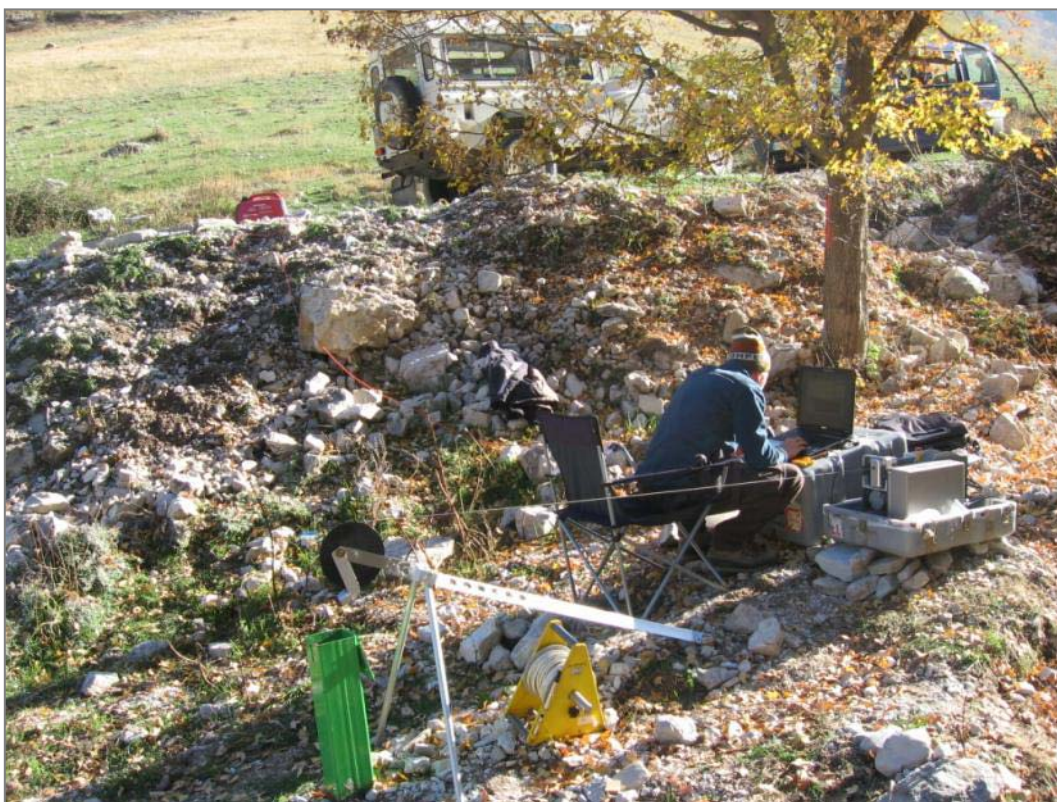
Figura 3.4 - Strumentazione esterna del Flowmeter Heatpulse in occasione del suo utilizzo nella campagna di Novembre 2011.
