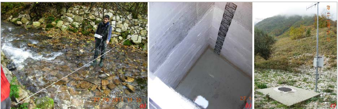
Figura 4.13 – a) Ubicazione della sezione di misura As904 in prossimità della stazione di monitoraggio del CIIP Spa; b) Asta idrometrica interrata collegata ai sensori per il telerilevamento ( c ) della misura del livello idrometrico.
