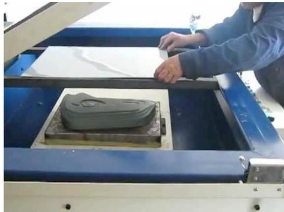
Ilustración 13 Proceso de termoformado. Fuente: termoformadodeplasticos.com [9]
