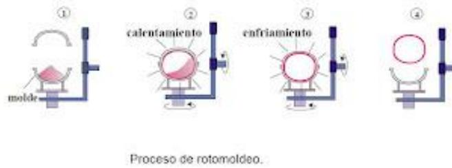
Ilustración 11 Proceso de rotomoldeo. Fuente: blogspot [8]
