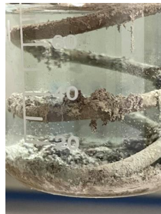
Figura 22. Sustitución de cobre por plata. Figura 23. Resultado de la práctica.
