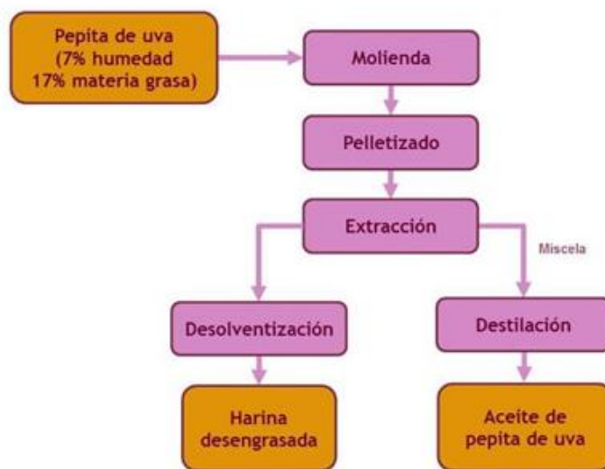
Figura 13: Esquema de la obtención de aceite de pepita de uva. Fuente: http://www.agralco.es/productos/aceite-de-pepita/
