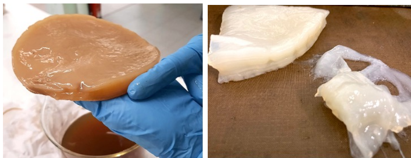
Figura 5. (a) Celulosa bacteriana a partir de la Kombucha SCOBY antes del lavado. (b) Celulosa bacteriana a partir de la Kombucha SCOBY después del lavado con NaOH overnight
