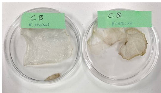
Figura 6. Comparativa de la CB K. Xylinus con la CB Kombucha una vez secas
