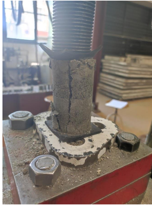
Imatge 25 Proveta amb trencament longitudinal
