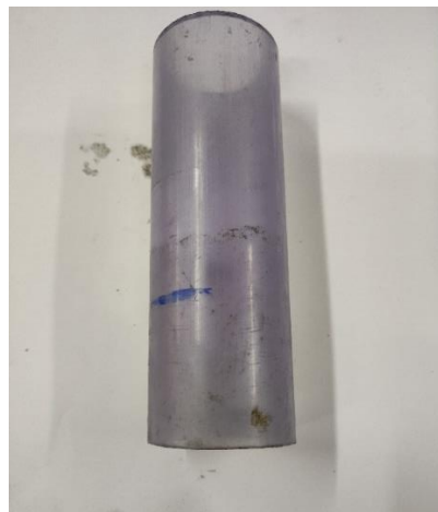
Imatge 12 Proveta utilitzada per l'encofrat d'una mostra
