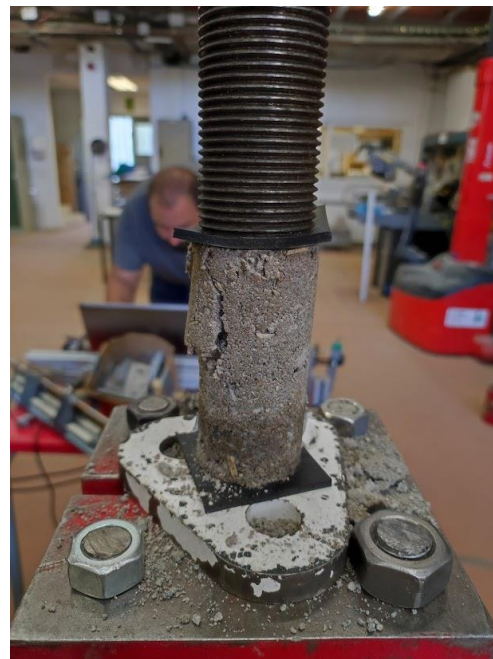
Imatge 26 Proveta amb trencament local
