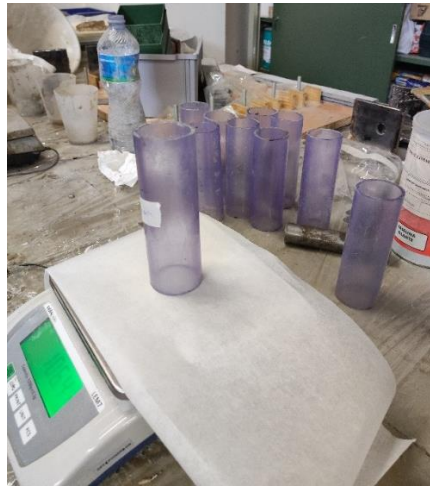
Imatge 16 Identificació i mesurament del pes d'un motlle
