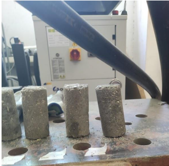
Imatge 27 Provetes defectuoses
