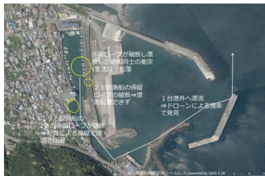
図-4 佐喜浜漁港の被害概況
