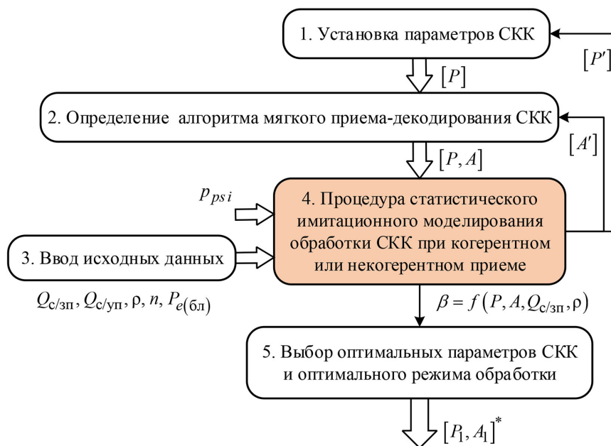
Рис. 2. Структура метода оптимизации параметров сигнально-кодовой конструкции и режима ее обработки при когерентном или некогерентном приеме
