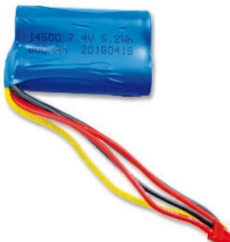
Εικόνα 2.3: Τυπική διάταξη πολλαπλών μπαταριών LION
