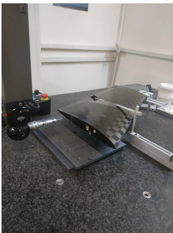
Εικόνα 2.5α: Μέτρηση σε CMM
