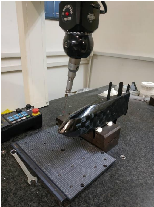
Εικόνα 2.6α: Μέτρηση σε CMM
