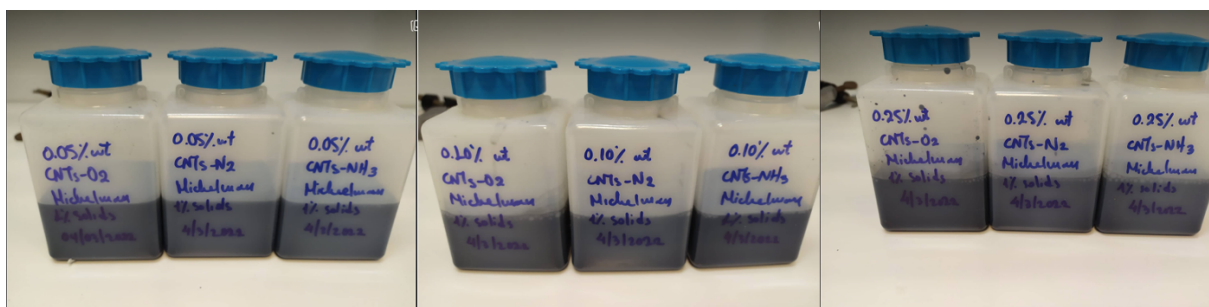
Σχήμα 3.21: Διαλύματα sizing με προσθήκη CNTs α) με επιφανειακές τροποποιήσεις O 2 – N 2 – NH 3 σε περιεκτικότητα 0.05% β) με επιφανειακές τροποποιήσεις O 2 – N 2 – NH 3 σε περιεκτικότητα 0.1% και γ) με επιφανειακές τροποποιήσεις O 2 – N 2 – NH 3 σε περιεκτικότητα 0.25%.
