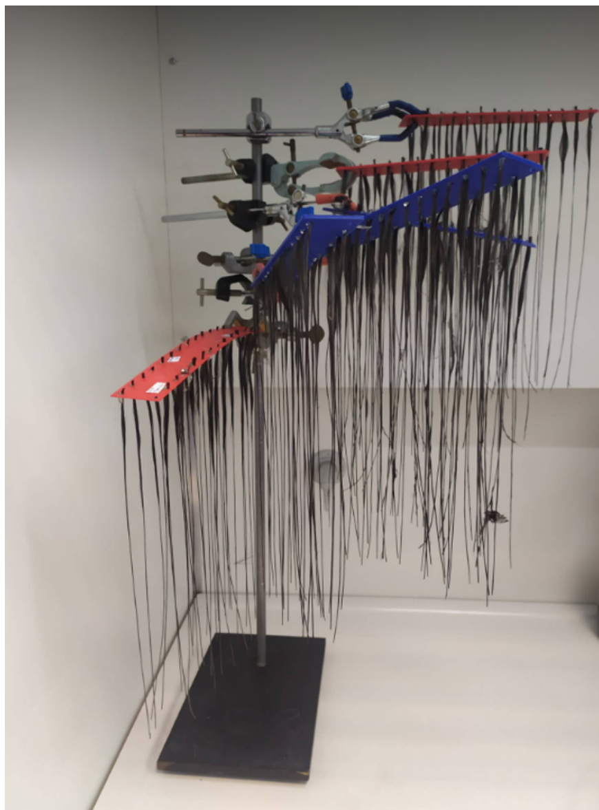
Σχήμα 3.24: Δείγματα ίνας άνθρακα μετά τη διαδικασία sizing με νανοσωματίδια.
