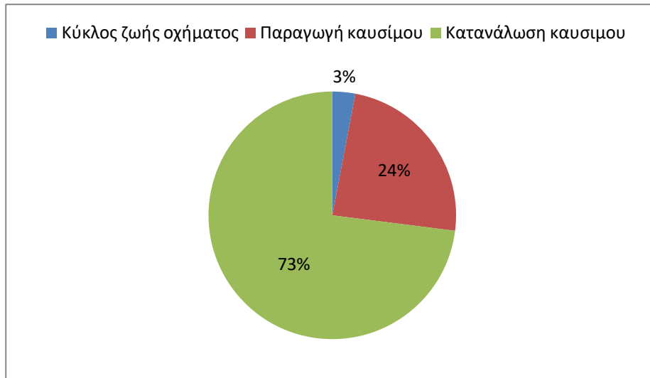
Σχήμα 3.4: Συμβολή διαφορετικών σταδίων του κύκλου ζωής στις συνολικές εκπομπές GHG από ένα στόλο βαρέων επαγγελματικών οχημάτων που λειτουργούν με ντίζελ [38].
