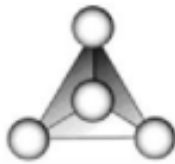
ΕΙΚΟΝΑ 5.1.2.a: Μονομελές τετράεδρο ( Nesosilicates ) το απλό ιόν (SiO_4)^{4-} . [35]
