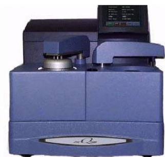
ΕΙΚΟΝΑ 7.a : DSC Q200 – Αναλυτικό ζυγό – Πρέσα[40], [41]
