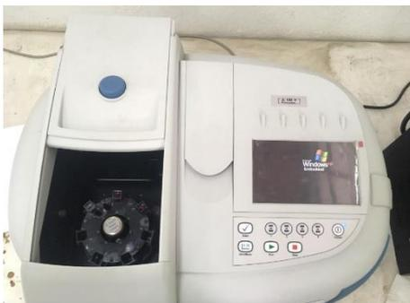
Imagen 14: Espectrofotómetro usado para medición de actividad antioxidante y contenido de vitamina C.
