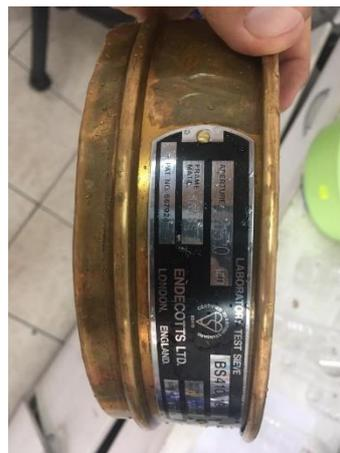
Imagen 3: Malla de 25 µm usada para filtrado del jugo de mandarina.
