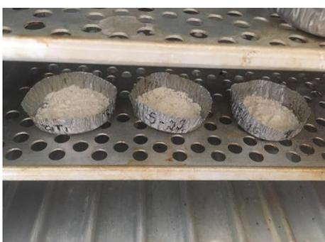
Imagen 6: Medición del contenido de humedad de los microencapsulados.
