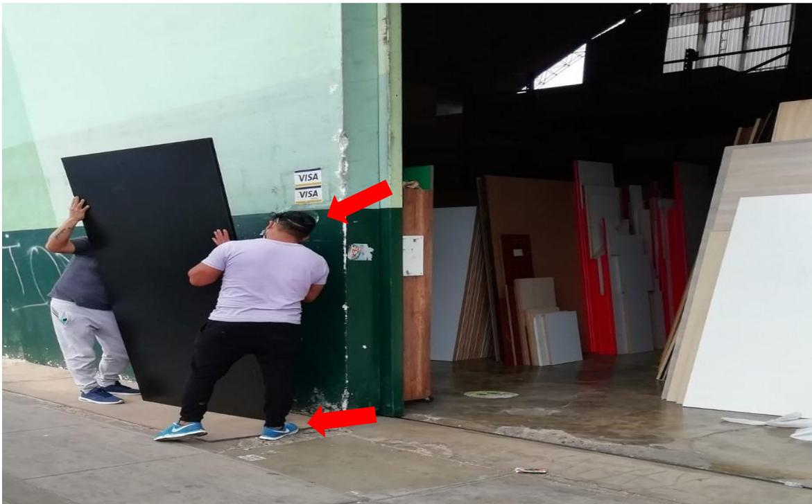
**Foto N.º 8 Operario de carga corriendo sin botas y casco**
