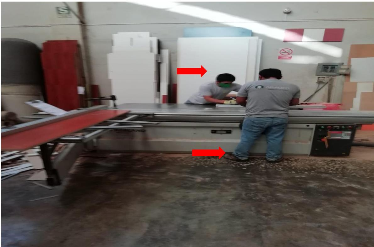
**Foto N.º 2 Operarios de máquinas no usan casco, botas y protector respiratorio**
