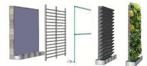
Ilustración 3-56: composición de un muro verde. Fuente: planta oxígeno.com
