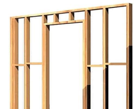
Ilustración 4-22: panel estructural fuente: HectorScerbo, estructuras de madera.
