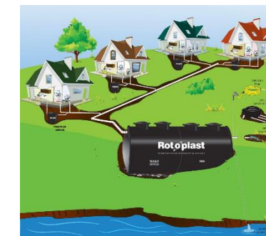
Ilustración 3-60: fosa séptica y salida hacia el sustrato. Fuente: ruralsupplies.eu
