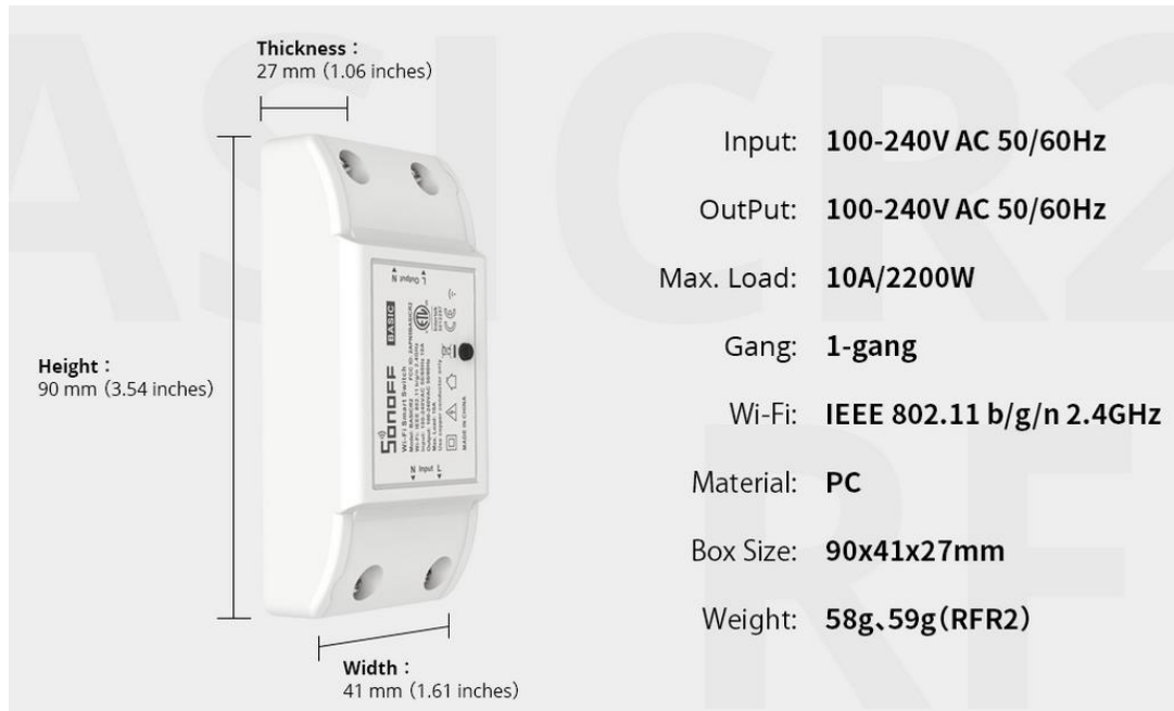
Figura 54: Características Del Sonoff Basic
