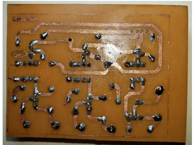
Figura 22: Soldadura De La Terminada.
