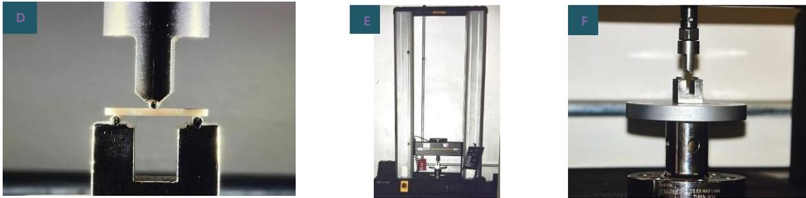
D y E.- Prueba de flexión en tres puntos. F.-Maquina universal de pruebas INSTRON.
