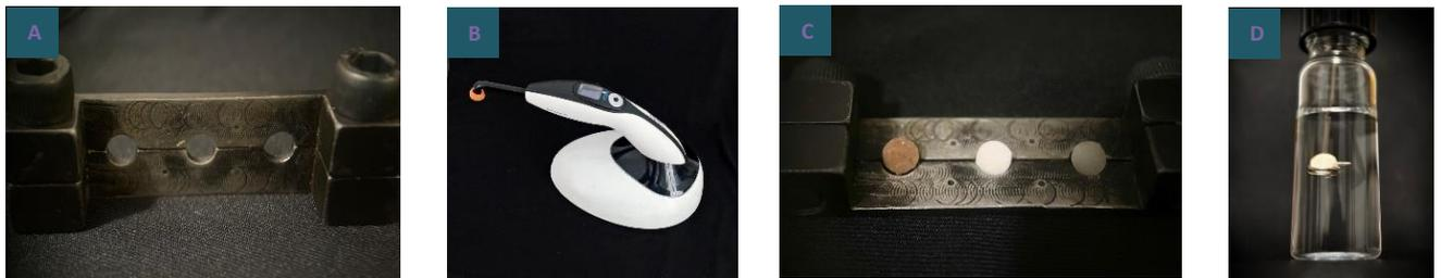
A.- Molde de acero inoxidable. B.- Lampara de fotocurado Bluphase N100 C.- Muestras fotopolimerizadas por ambos lados de los tres grupos de estudio. D.- Muestra sumergida en agua tridestilada.
