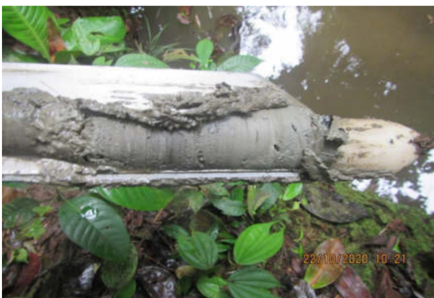
Vista cercana del sedimento (S0374-SED-002) de la quebrada sin nombre, se evidenció olor a hidrocarburos.
