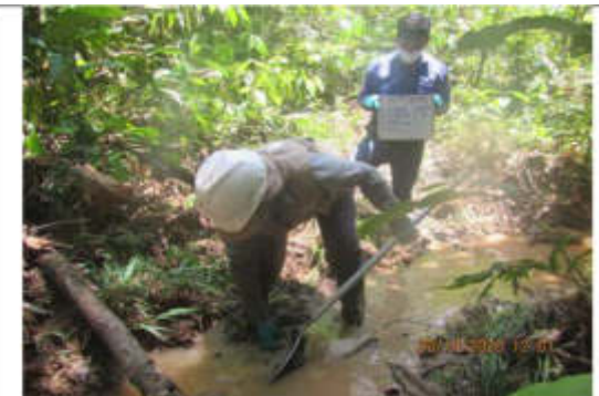
Muestreo de macrobentos con red D-net en el punto S0517-HB-002 en la quebrada s/n.
