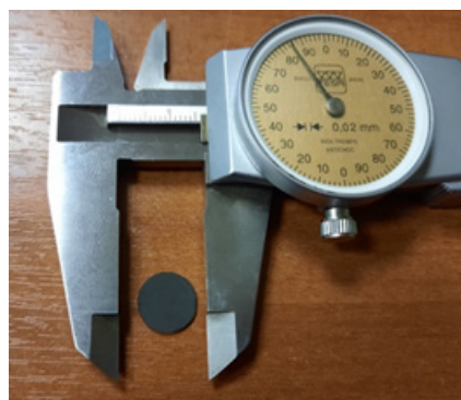
Рис. 5. Образец керамики холодного спекания из порошка (MnFeCoNiCu) 3 O 4 , относительная плотность 0.71 (температура 300 °С, 0.1 мас. % NaOH).
