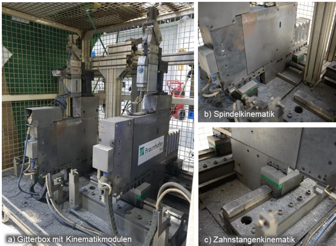
Abbildung 7-24: Gitterbox und Kinematik nach dem Schmutzdauertest
