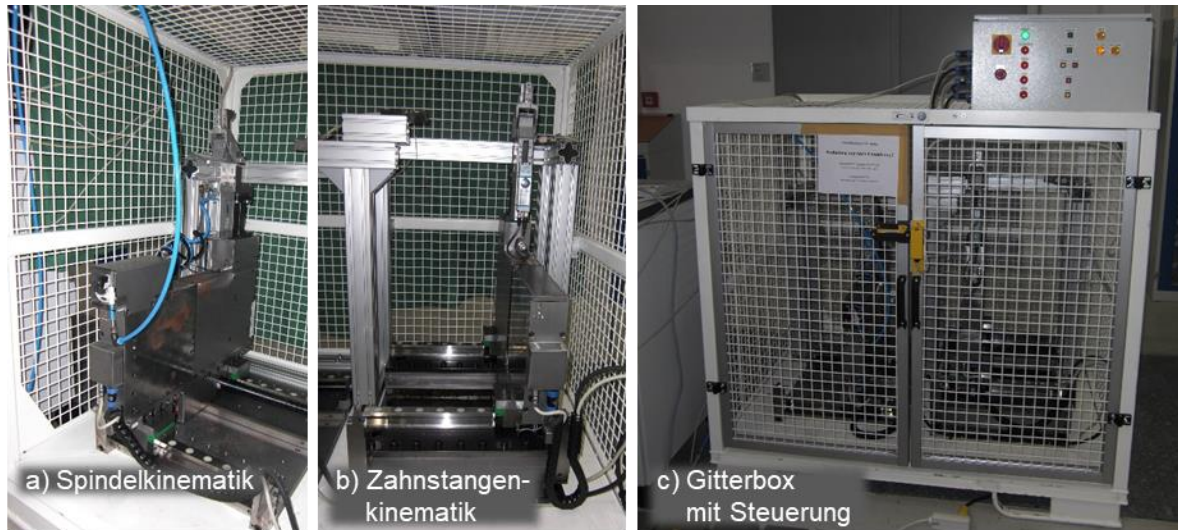
Abbildung 7-22: Gitterbox mit Kinematikmodulen für Schmutzdauertest
