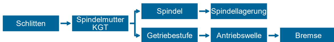
Abbildung 8-4: Kraftfluss im Antriebsstrang im statischen Belastungsfall
