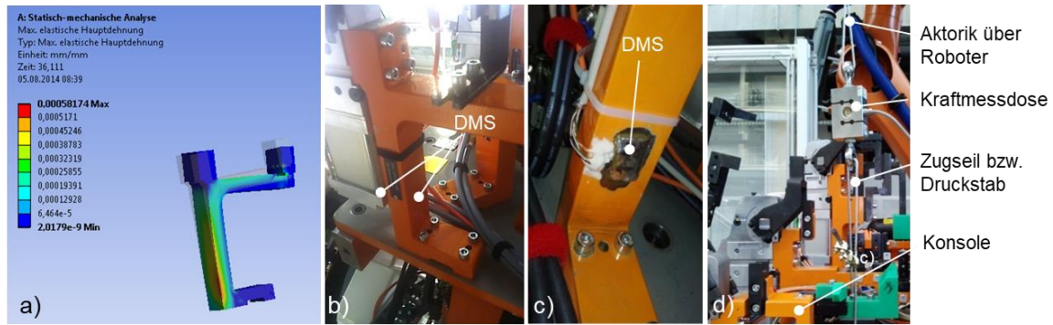
Abbildung 5-32: DMS-Applikation am Beispiel der Konsole 19
