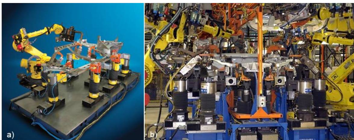
Abbildung 2-20: Vorrichtungs Aufbau mit F-100iA-Kinematiken; a) [FAN09] ; b) [VAS10]
