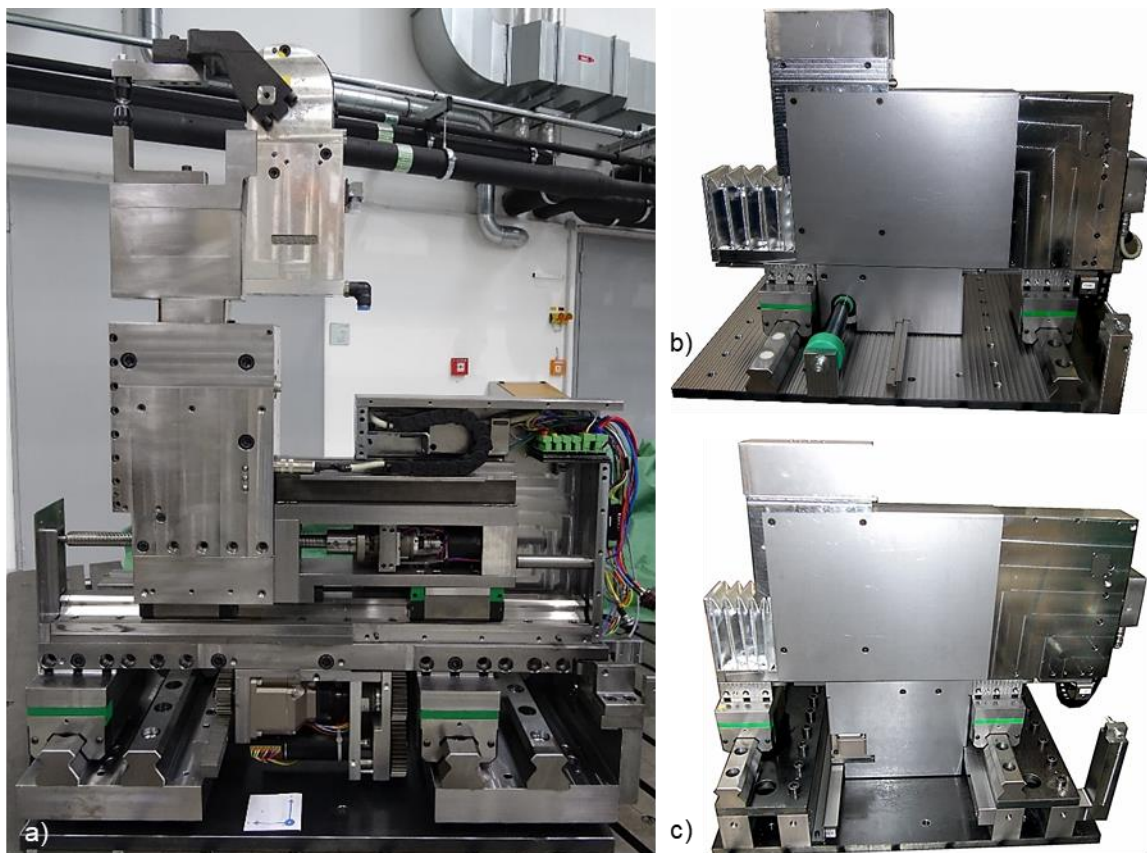
Abbildung 7-1: umgesetzte Prototypen; a) und c) Zahnstangenantrieb; b) Spindeltrieb
