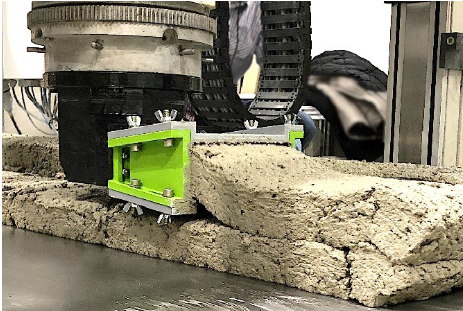
Bild 4 Der entwickelte Beton zeigt eine gute Verbaubarkeit und hinreichende Extrudierbarkeit. Foto: Markus Taubert
