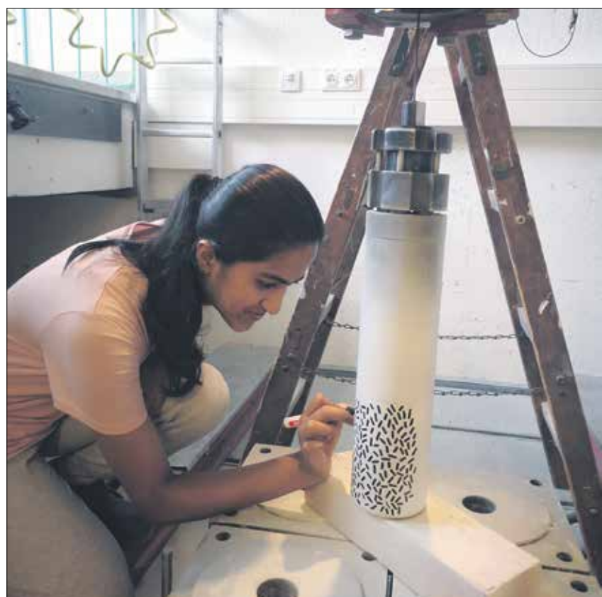
Studentin Riya Thomas bemalt einen Impaktor. Die Striche sind wichtig für die spätere Auswertung der Fallexperimente mit Hochgeschwindigkeits-Kameras.
