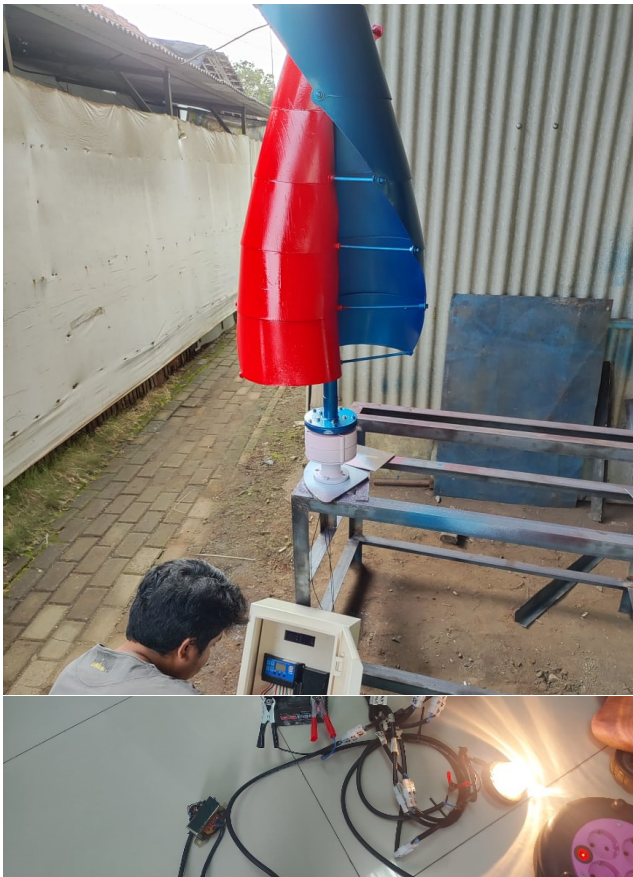
Gambar 5. Uji oba Turbin Angin sebelum di implementasikan pada Lokasi Mitra
