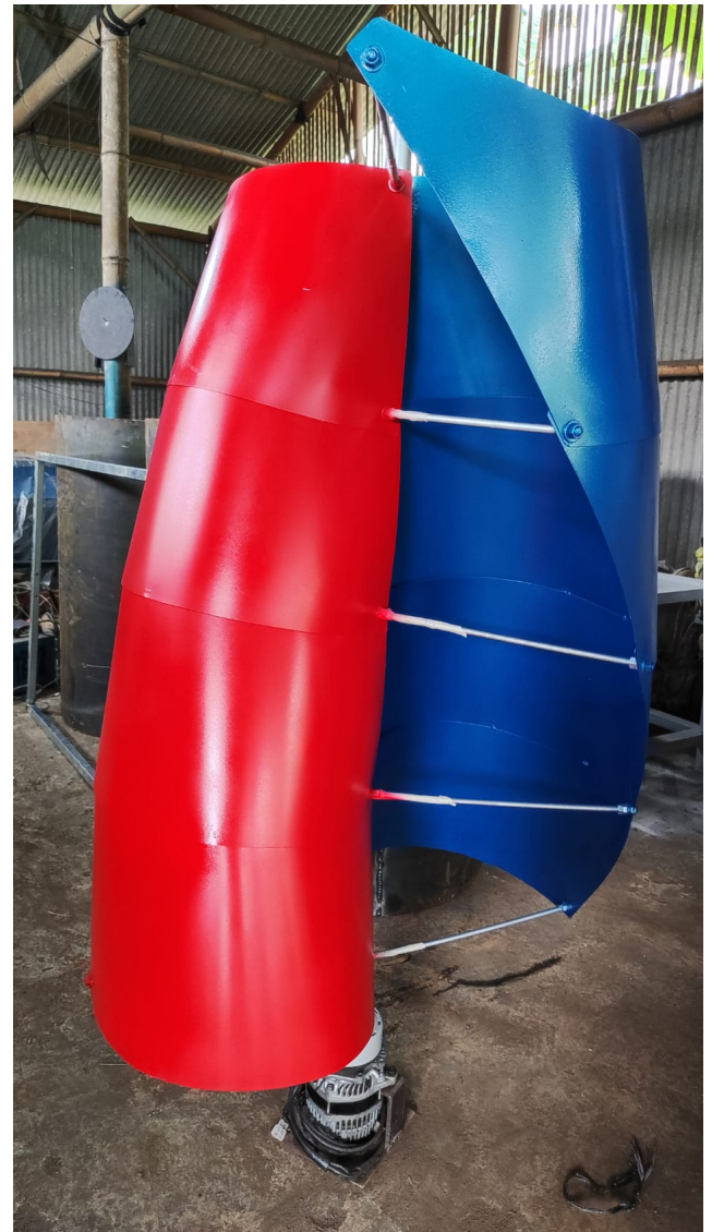
Gambar 3. Perakitan Turbin Angin Tipe Helix
