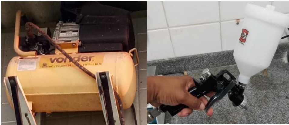
Figura 4- Sistema de revestimento de superfície por spray montado. À esquerda, compressor de alta pressão; à direita, “pistola” de pintura automotiva.
