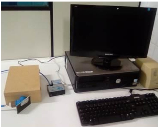
Figura 2 - Aparato experimental completo. Entre a caixa e o computador está o espectrofotômetro. Na frente do joelho de PVC podemos ver um espelho utilizado para a obtenção do espectro da lâmpada.
