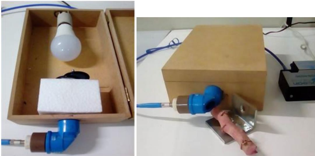
Figura 1 - À esquerda, aparato experimental já com o joelho de PVC, obturador de luz e a fibra ótica que vai para o espectrofotômetro. À direita, aparato experimental mostrando uma maniva de mandioca revestida com um filme de fungicida, na posição para a realização da leitura do referido sinal.
