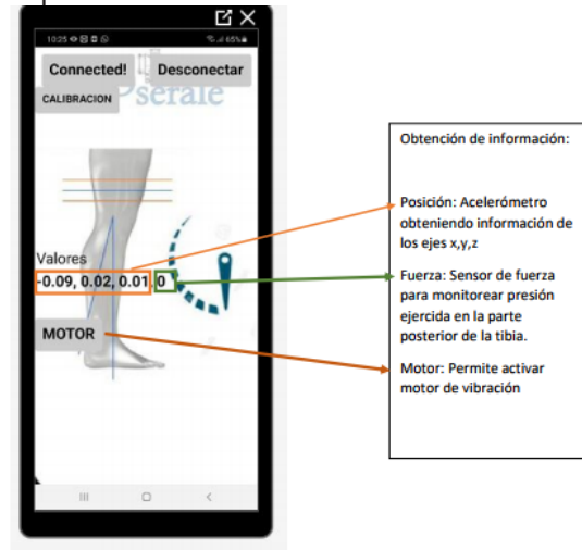
Figura 10 Entorno de pruebas de la aplicación administradora de cambios ortesis. Fuente: Elaboracion propia los autores
