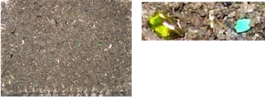
Figura 4.1 Materiale OF e frazioni di plastica e vetro residue presenti nel materiale
