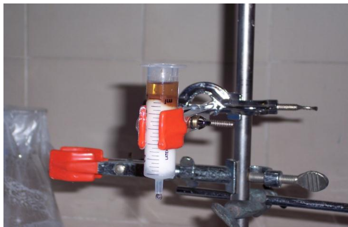
Figura A.2 Processo di desorbimento degli acidi fulvici adsorbiti alla resina
