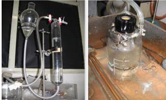
Figura 5.1 Eudiometro e particolare di una bottiglia collegata ad esso
