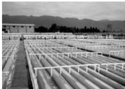
Figura 3.16 Fotobioreattore tubulare di grande diametro in scala commerciale
