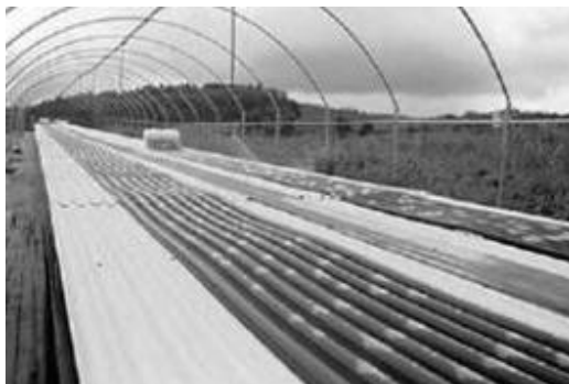
Figura 3.15 Fotobioreattore tubulare inclinato con scambio interno di gas
